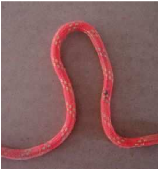
Σκλήρυνση σε μέρη του σχοινιού
